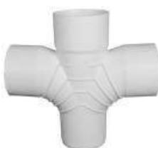
در راستای کنترل صدای درون سیستمهای فاضلابی جهت آسایش ساکنین ، سیستم اتصالات بی صدا ( Silent ) با طراحی منحصر به فرد با کمربندهای تقویتی روی آنها تولید و عرضه گردیده است . این محصولات برای کنترل صدای عبور سیالات از درون ناودانی و سیستمهای فاضلاب ساختمانی قابل استفاده میباشد . کمربندهای تقویتی تعییه شده بر روی اتصالات ، هنگام برخورد سیالات منجر به شکستن ، پخش و در نتیجه ایجاد حداقل صدا میشود . همچنین این رینگها باعث افزایش مقاومت مکانیکی اتصالات میگردد .
