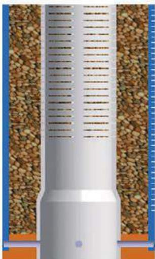
لوله های پری پک تولیدی PG برای استفاده در جدار چاه آب در مناطق ساحلی و شنزار چهت جلوگیری از ورود شن به داخل حلقه چاه و بالا بردن بازده و عمر پمپ طراحی و ارائه گردیده است . این نوع لوله از دو قطر و ضخامت مختلف و بر اساس استاندارد DIN 4925 تولید می شود که بین دو جداره لوله، گراول به قطر ۲ الی ۶ میلیمتر جاسازی شده که بصورت فیلتر عمل کرده و از ورود شن به داخل حلقه چاه جلوگیری و در نتیجه آب حاصله تمیز و عاری از عوامل خوردگی می باشد .
